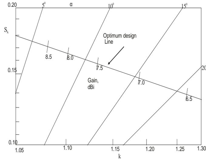
**Figure1. Log-Periodic array design parameters curve.**
