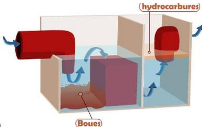
Figure 3. schéma de fonctionnement d'un débourbeur/déshuileur
